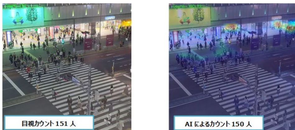
図 2: 実験結果例 検証期間を通じて夜間測定の誤差は±10%以内 (リッジアイによる検証)
