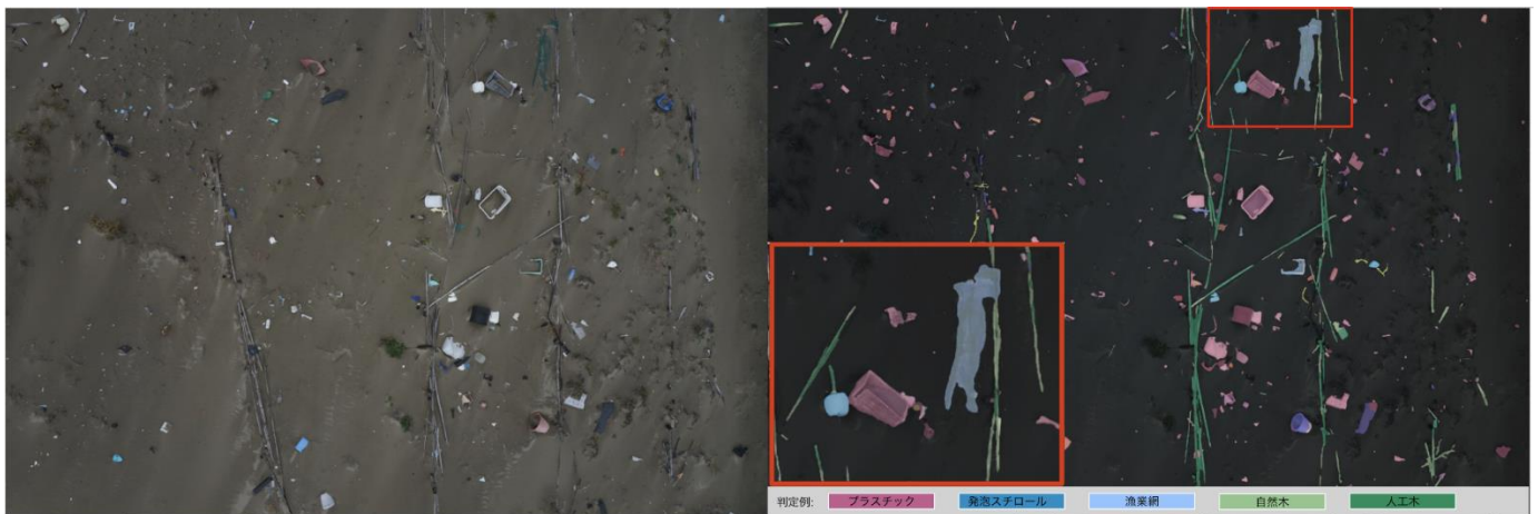
▲ リッジアイが開発した海洋ごみ解析 AI を使用し、ごみの分布状況や量を解析し海洋ごみ調査レポートを作成 (左) 砂浜海岸の撮像画像 (右) 海洋ごみ解析 AI の出力結果
